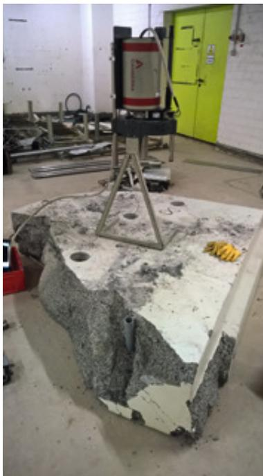
Abb. 5: Zyklotron 1 – Messung von freigabefähigen Materialien (Beton)
