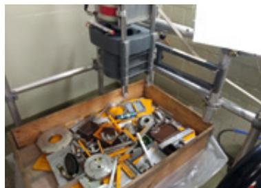
Abb. 7: Zyklotron 2 – Messung von freigabefähigen Materialien
